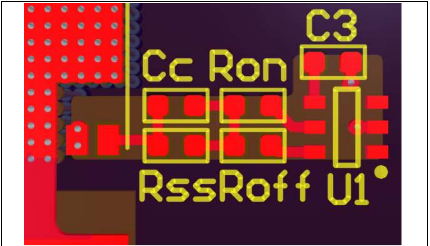
图 14 更详细地了解 0 中的栅极驱动回路布线
