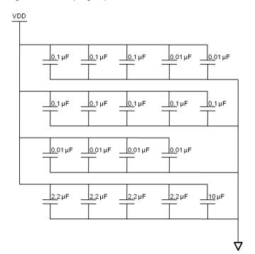
Figure 42. Decoupling Capacitor Recommendation for  $V_{\text{DDQ}}$
