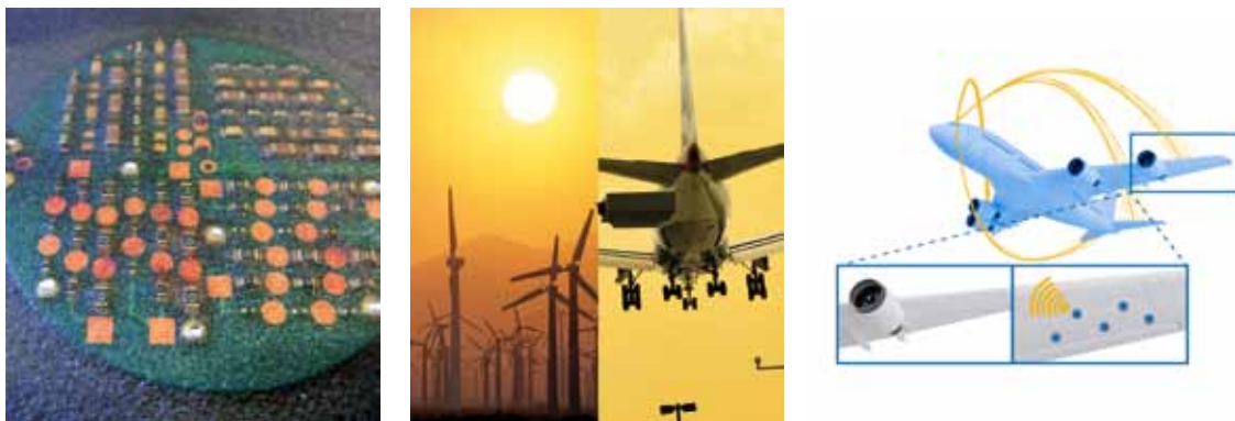
Abbildung 7: In Kohlefaser-Komponenten (CFK-Werkstoff) integrierte autark arbeitende Sensorknoten zur frühzeitigen Riss-Detektion z. B. in Flugzeugen oder Windkraftanlagen
