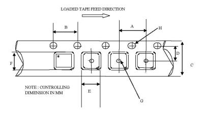
CARRIER TAPE DIMENSION FOR MLPQ4X4V
