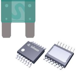
Die Chips dienen jedoch nicht allein als smarter Ersatz herkömmlicher Sicherungen. Zusätzlich sind sie in der Lage, Steuerungsfunktionen zu übernehmen. Ein gutes Beispiel dafür ist die Scheibenwischeranlage: In Kombination mit einem Regensensor lassen sich mit diesem sieben mal sieben Millimeter großen Mixed- Signal-Mikrocontroller unter anderem die Wischintervalle steuern.
