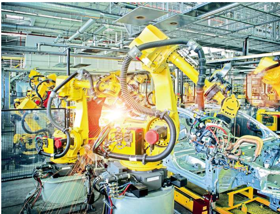
Bild 1: Die Steuerungseinheit für die Bewegung ist mit jedem Aktor separat verkabelt; Endeffektoren benötigen ein eigenes Kabelbündel.
