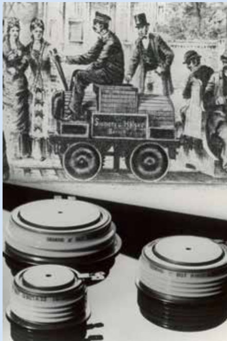
Bild 2: GTO der Serie BGT (1987) für Strom von 900 A bis 2 kA und Sperrspannungen von 1,8 bis 2,5 kV.
