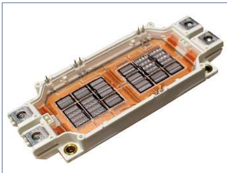
Bild 2: EconoDUAL 3, FF600R12ME4A mit Kupferbonddrähten für die Verbindung auf DCB-Ebene und der neuen, hochzuverlässigen Systemlötung.
