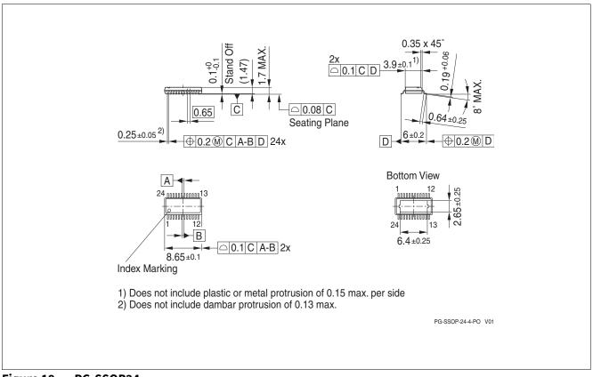
Figure 19 PG-SSOP24
