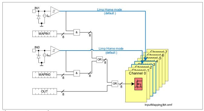
Figure 10 Input Mapping
