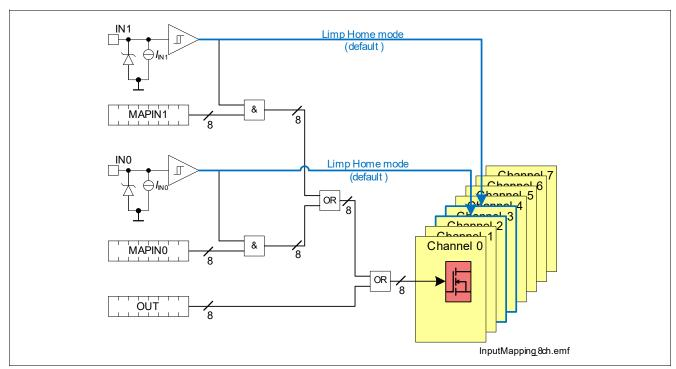
Figure 10 Input Mapping
