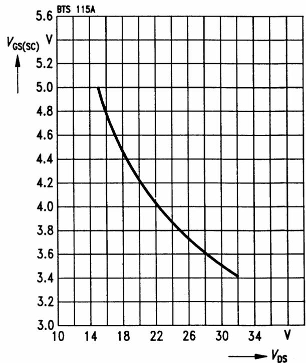
Figure 3: Example „Short circuit protection“ and „Max. gate voltage“ diagram
