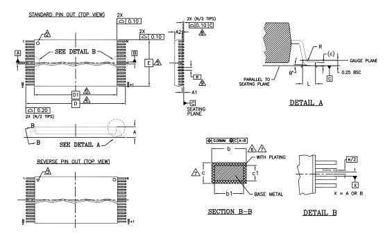
Figure 34. TS056—20 × 14 mm, 56-pin TSOP (PL127J)
