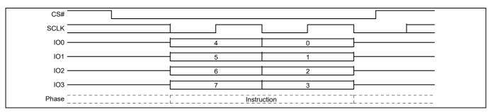
Figure 67 Enter 4 Byte Address QPI mode
