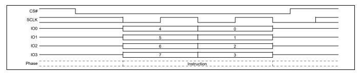
Figure 56 Enter 4 Byte Address QPI mode
