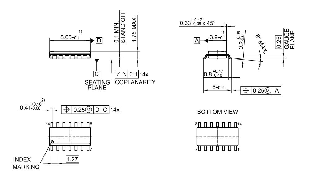
1) DOES NOT INCLUDE PLASTIC OR METAL PROTRUSION OF 0.15 MAX. PER SIDE 2) DOES NOT INCLUDE DAMBAR PROTRUSION OF 0.127 MAX.
