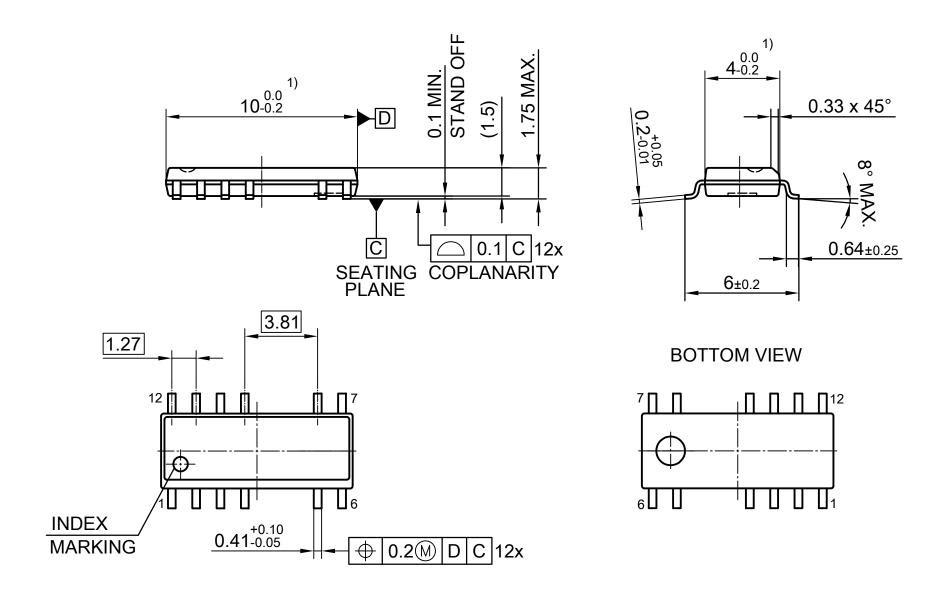
1) DOES NOT INCLUDE PLASTIC OR METAL PROTRUSION OF 0.25 MAX. PER SIDE
