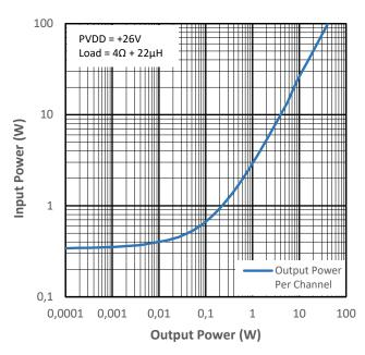
Load =  $4\Omega + 22\mu H$ 10 Input Power (W) 1 Ш Output Power Per Channel 0,1 0,0001 0,001 0,01 0,1 1 10 100 **Output Power (W)**
