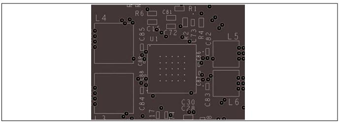
Figure 21 LAYER 2 – GROUND PLANE
