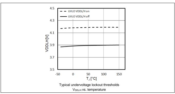
Figure 8 V<sub>DDL/H</sub> UVLO
