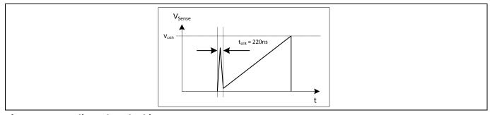
Figure 19 Leading Edge Blanking
