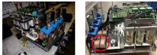
图2：两个构建的演示装置堆栈的照片：(左)采用FF1400R17IP4的堆栈，(右)采用FF1800R17IP5的堆栈。
