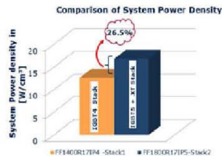
图4: IGBT4和IGBT5堆栈系统功率密度的比较。
