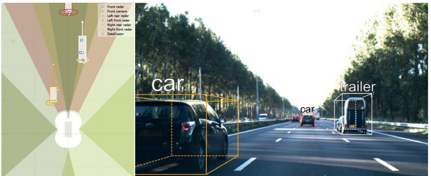
図2: センサーフュージョンは、さまざまなセンサー (左) からの入力を組み合わせて、車両周辺の物体 (右) を統一された情報として提供
