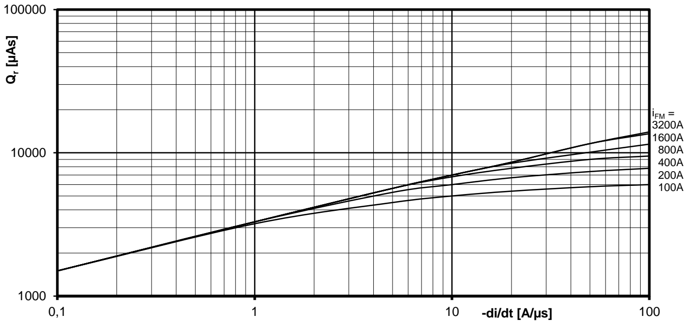
Sperrverzögerungsladung / Recovered charge Q_r = f(-di/dt)
