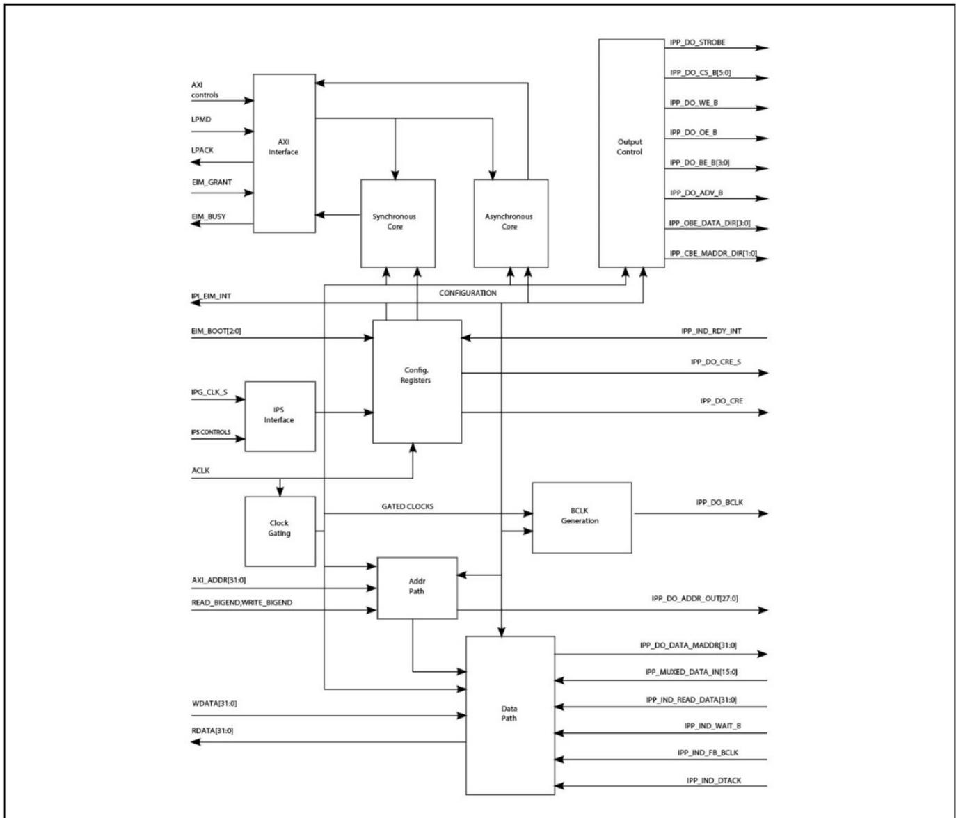
**Figure 2 i.MX6x EIM Block Diagram**
