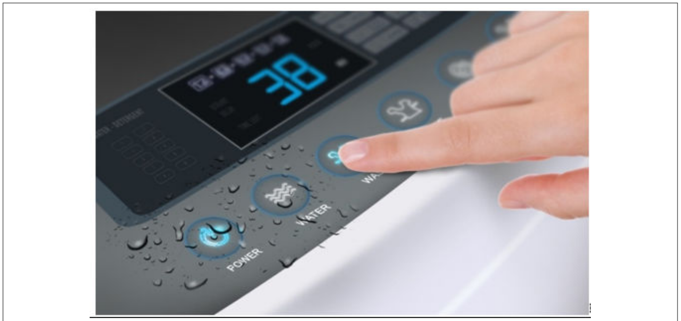
図 22 洗濯機での耐液性のある CAPSENSE™ベースのタッチ ユーザー インターフェース
