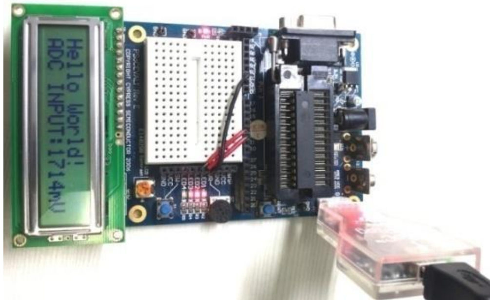
図 27. 電源とプログラム接続
