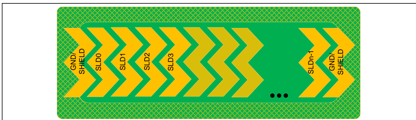
Figure 110 最初と最後のセグメントが最上層のハッチに接続されているリニア スライダーのパターン
