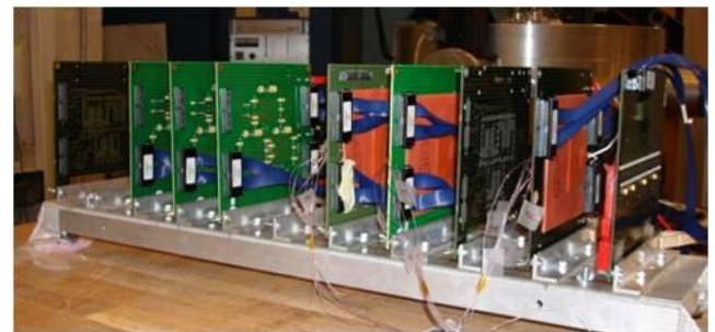
图 4. 演示测试板被夹在各校准板之间的照片
