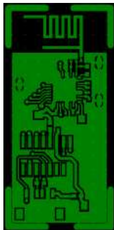
Figure 7. Substantial Top Copper Pour
