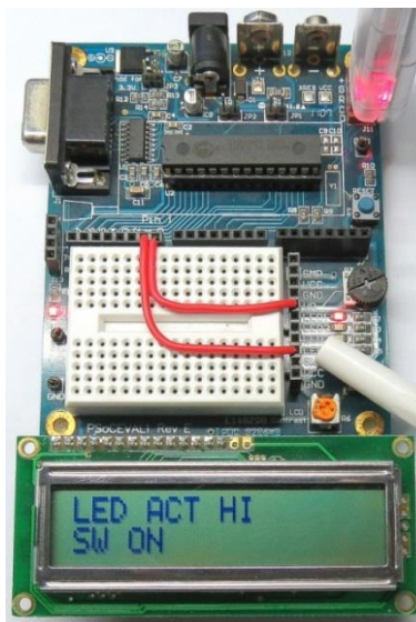
図 13. 例 1 の出力 - LED アクティブ HIGH
