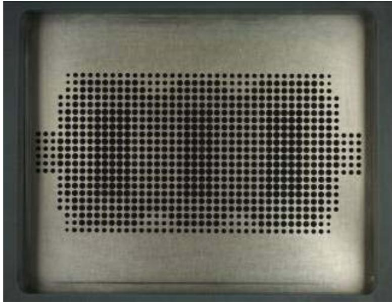
**Figure 7** Screen print template for an HybridPACK™ 1 module
