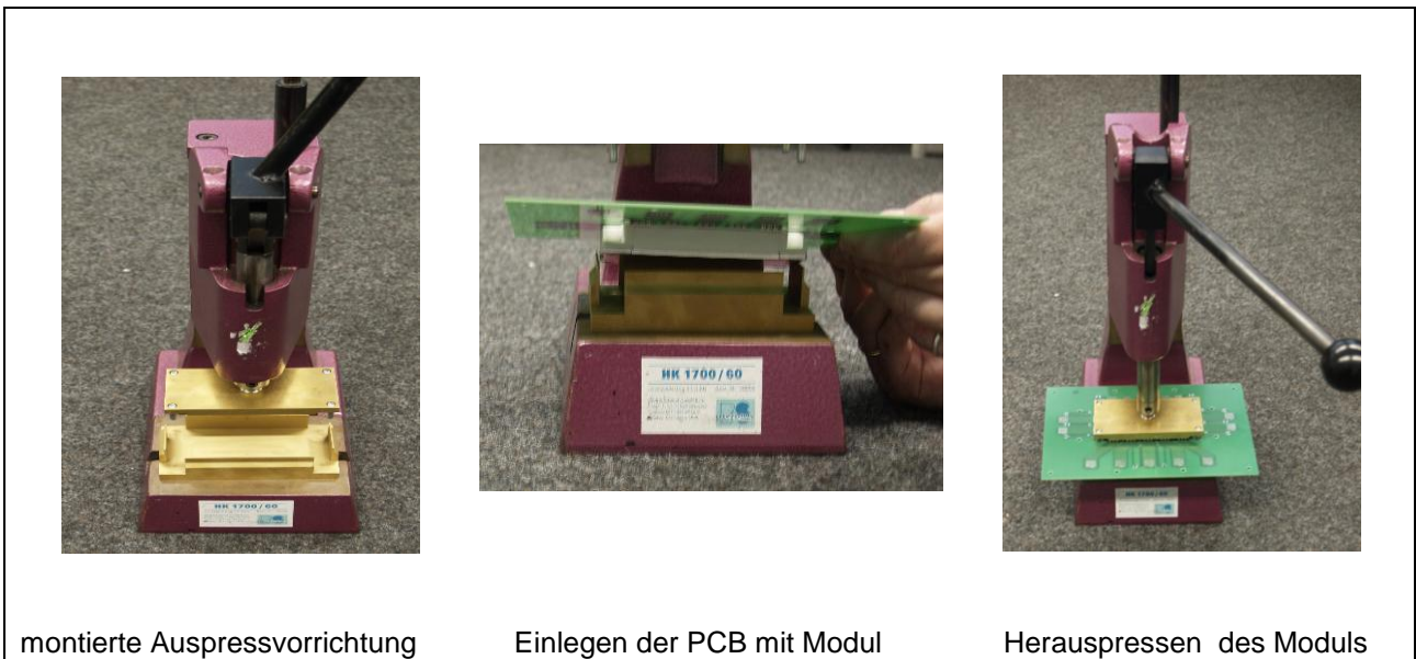
Bild 19: Auspressvorgang eines Econo3 Moduls
