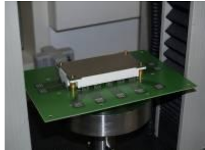
Bild 9: Leiterkarte mit Modul
