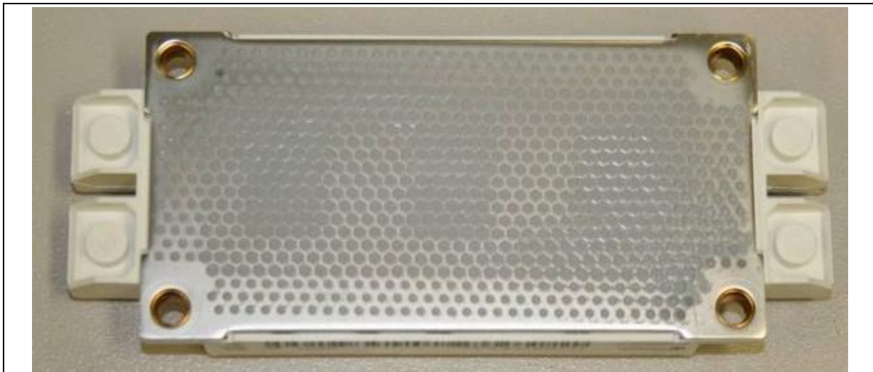
Abbildung 8 Bodenplatte eines EconoDUAL™3 nach dem Auftrag der WLP im Siebdruckverfahren
