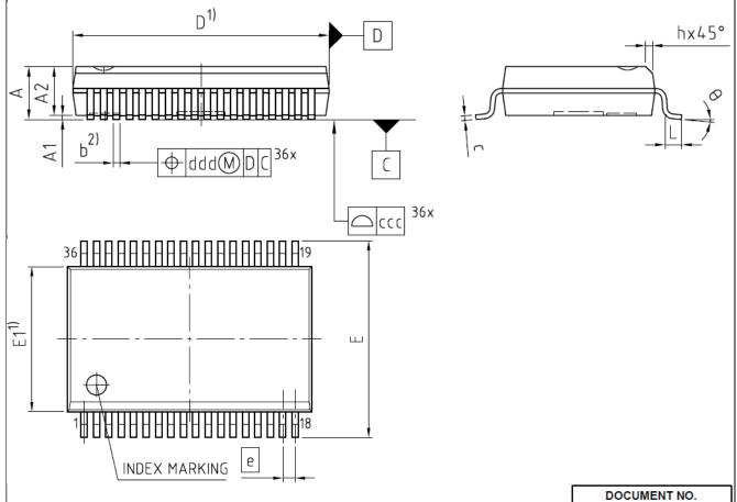
1) DOES NOT INCLUDE PLASTIC OR METAL PROTRUSIONS OF MAX 0.15MM PER SIDE. 2) DOES NOT INCLUDE DAMBAR PROTRUSION OF MAX 0.10MM.
