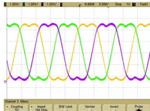
(d) 3-phase SAPWM modulated waveforms
