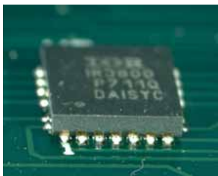
図5 プリント回路基板と平行にデバイスが実装される
