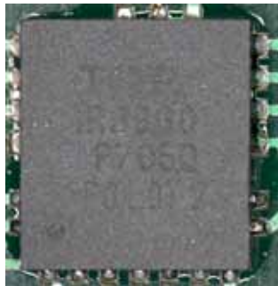
図4 はんだフィレットが良いと自動的に中心に配置される
