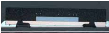
図10 傾き1度のPower QFNの断面図
