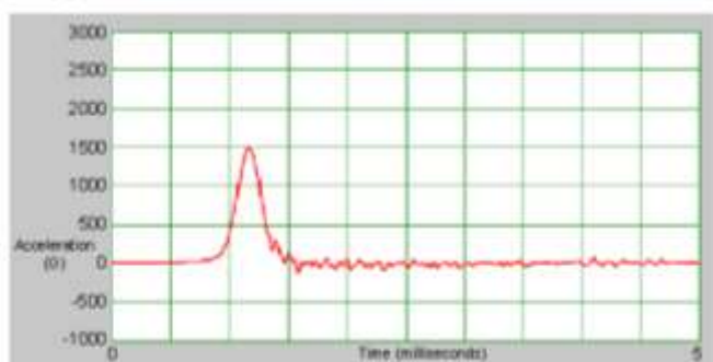
図11 落下試験の衝撃波形
