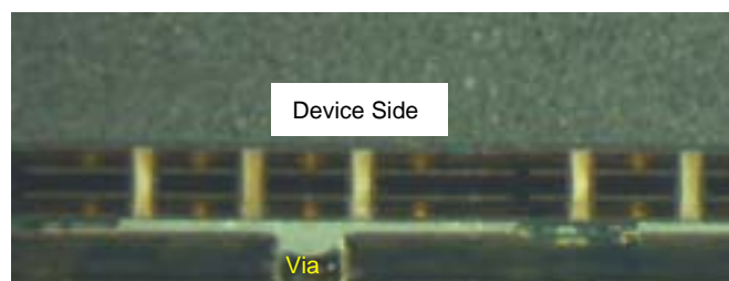
図7 パッド内に 20 ミルのビアがあるときのはんだ接続
