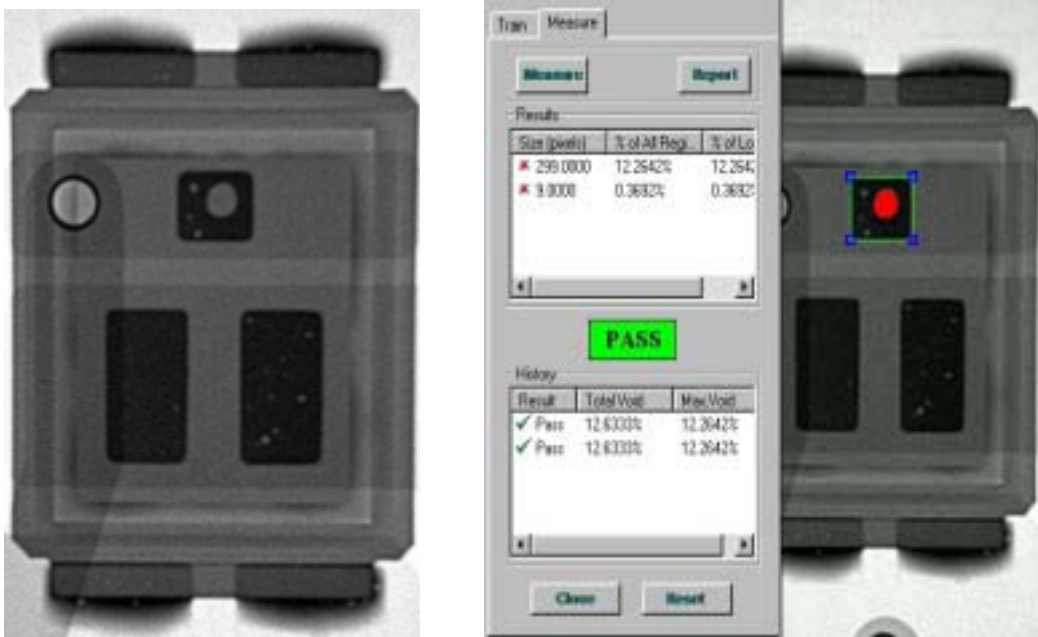
図 12 ゲート接続のはんだボイド
