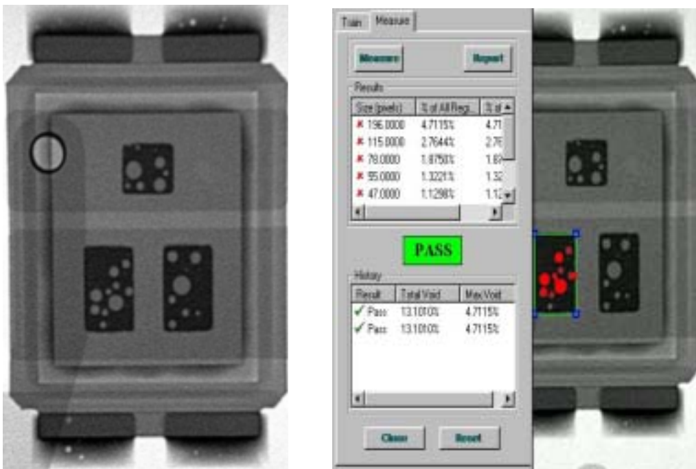
図 13 左のソース接続部のはんだボイド
