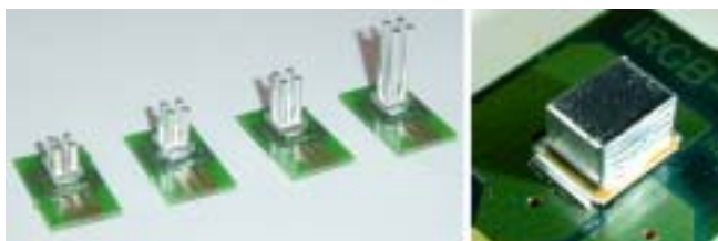
図 11 デバイスの上にヒートシンクを取り付けた例
