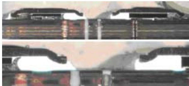
図 16 デバイスの下に流れ出したヒートシンクの接着剤
