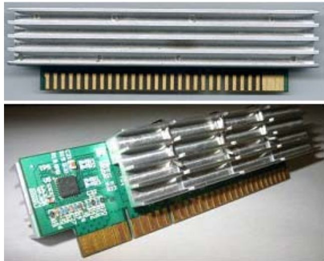
図12 複数のデバイスにヒートシンクを装着した例
