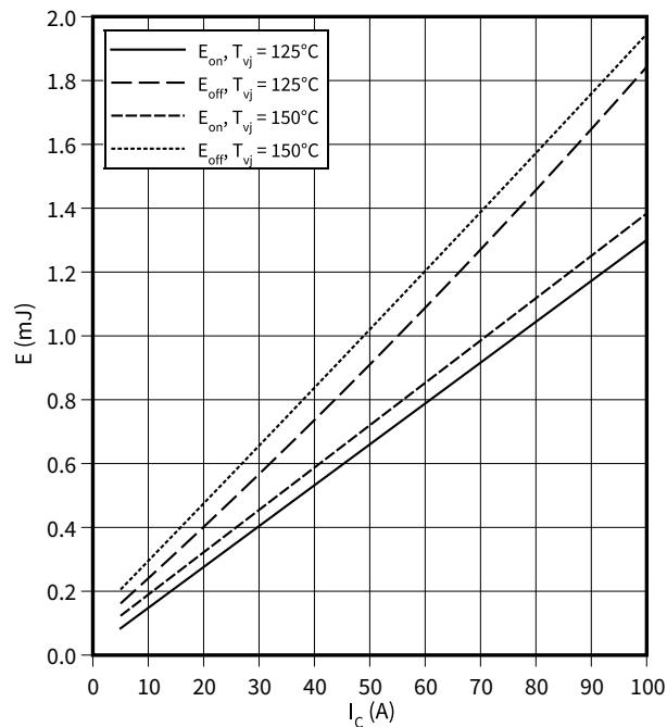
**スイッチング損失 (Typical), IGBT、スリー・レベル**
