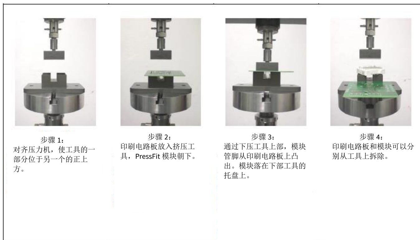
图 10 Easy 模块的挤压
