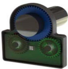
誘導式ステアリング角度センサー (TLE4803)
