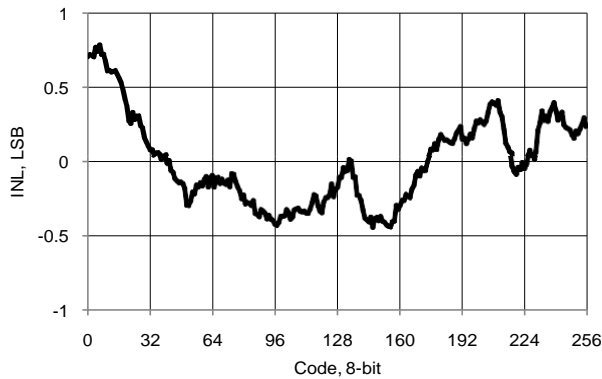
图 11-56. VDAC INL 与输入代码，1 V 模式
