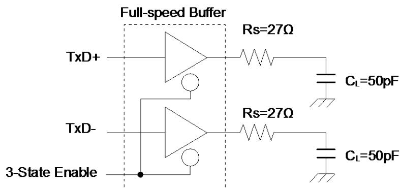
\*6:在  $90\Omega \pm 15\%$  的特性阻抗(Differential Mode)下，通过双绞线电缆屏蔽可以进行 USB Full-speed 连接。
