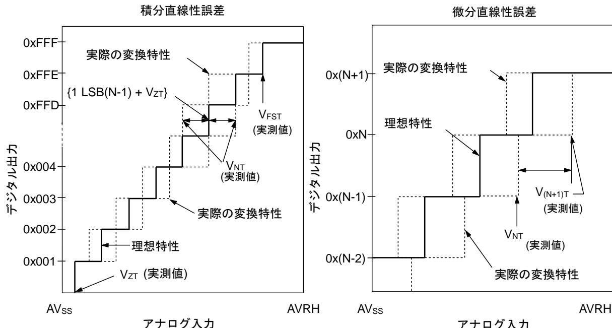
$$\text{デジタル出力 } N \text{ の積分直線性誤差} = \frac{V_{NT} - \{1\text{LSB} \times (N - 1) + V_{ZT}\}}{1\text{LSB}} \text{ [LSB]}$$
