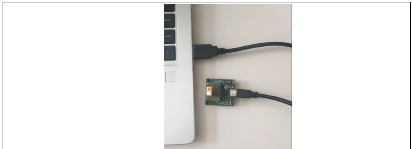
Figure 6 XENSIV™ PAS CO2 Sensor2Go 評価キットと PC をマイクロ USB ケーブルで接続
