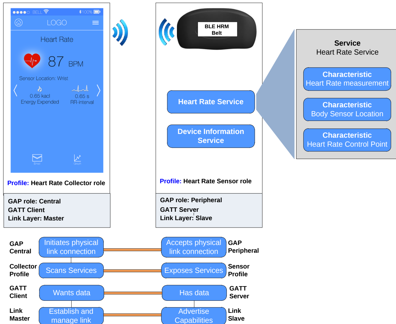
図 76. BLE 心拍数監視システム
